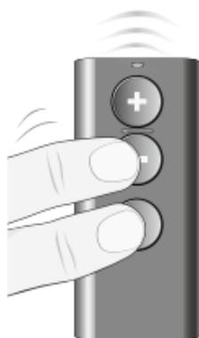
2. Die Statusanzeige blinkt 2 Mal wenn die Tastensperre aktiviert wird.
